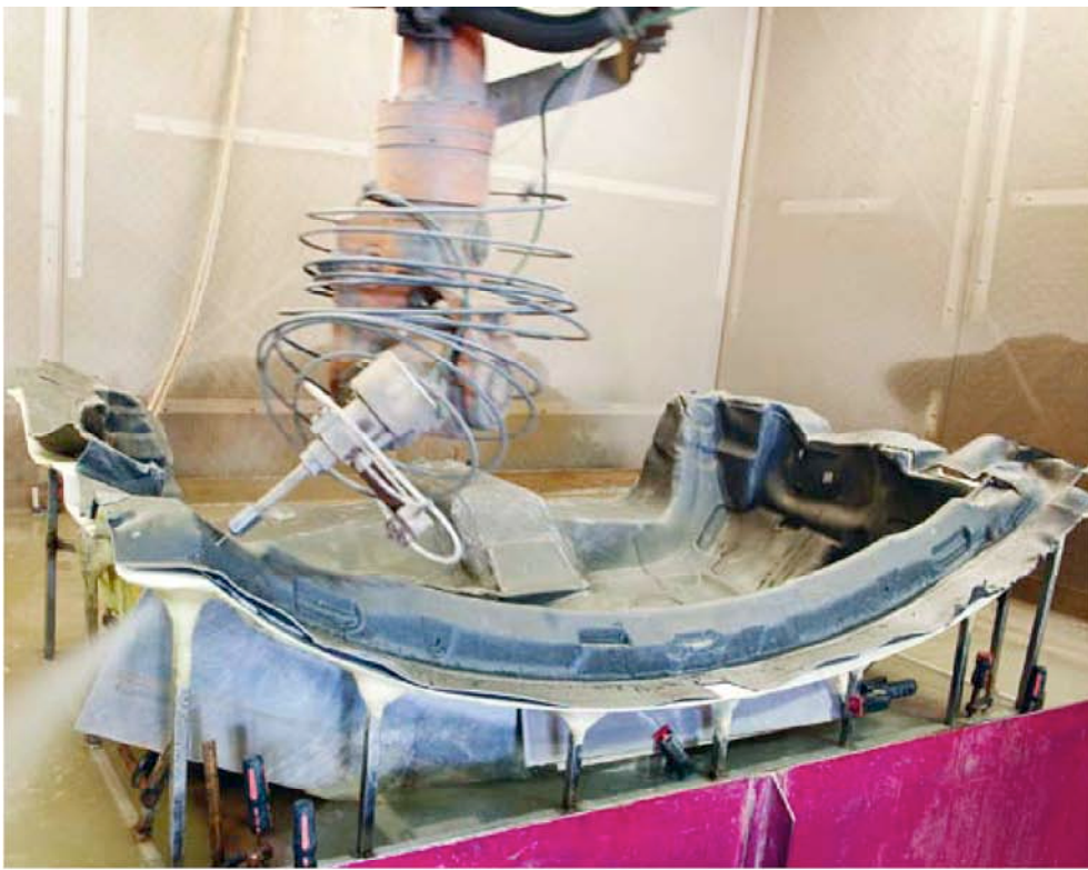
Alu-Verformung auf selbst entwickelten Maschinen mit selbst gebauten Werkzeugen.
